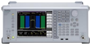
シグナルアナライザ MS2830A 周波数範囲： opt.040：9 kHz～3.6 GHz*3 opt.041：9 kHz～6.0 GHz*3
