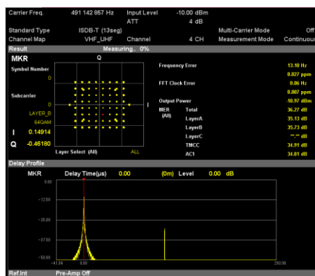
変調解析 測定画面例 (下側：遅延プロファイル)
