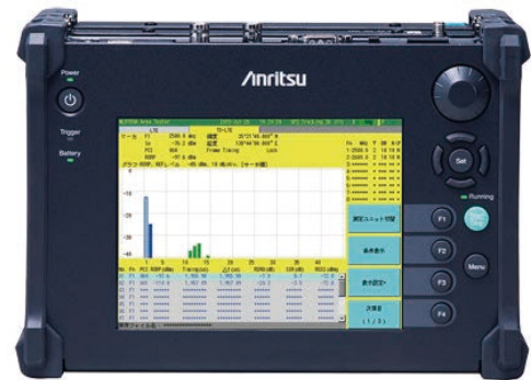
エリアテスタ ML8780A。ローカル5Gサービス開始前のエリア設計および基地局置局フェーズにおける基地局の電波伝搬環境調査、屋内外サービスエリア内におけるヒートマップ作成に用いられる
