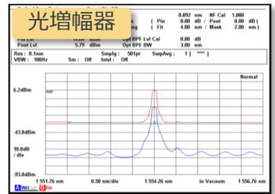
■ フィルタ特性評価も簡単。Trace機能で10個の波形を表示、演算可能
